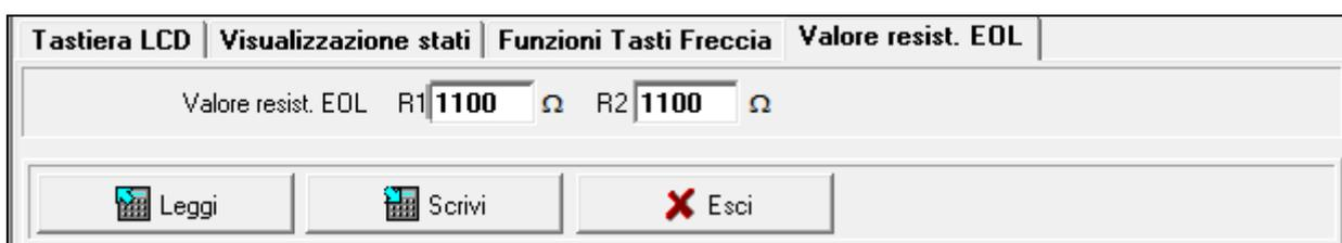
Fig. 8. La scheda "Resistenze di bilanciamento" nel programma DLOADX.
