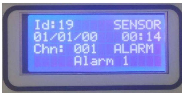
Fig. 3-5) Dettagli evento di Allarme 1
