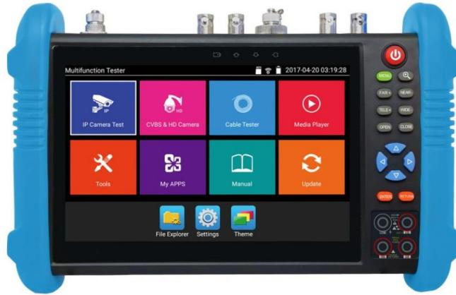
Tester TVCC multifunzione 6 in 1 con schermo touch da 7" con supporto per CVI/TVI di fino a 8MP, AHD di fino a 5MP, SDI e IP H.265/H.264 da 4K, Wi-fi, uscita di potenza PoE
