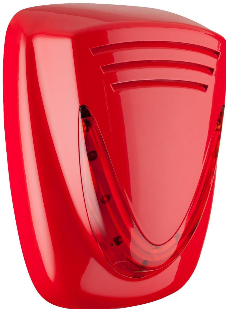
**Murano F24EN:** Alimentazione 24Vdc - lampeggiante a led a basso assorbimento e alta luminosità – programmazione suono e temporizzazione – programmazione di comando sirena e lampeggiante separati – circuito elettronico protetto da inversione di polarità e tropicalizzato in resina ad immersione. Tre ingressi con suoni differenti per una miglior distinzione del tipo di allarme, ingresso per sincronismo suono. Disponibili sei suoni.
