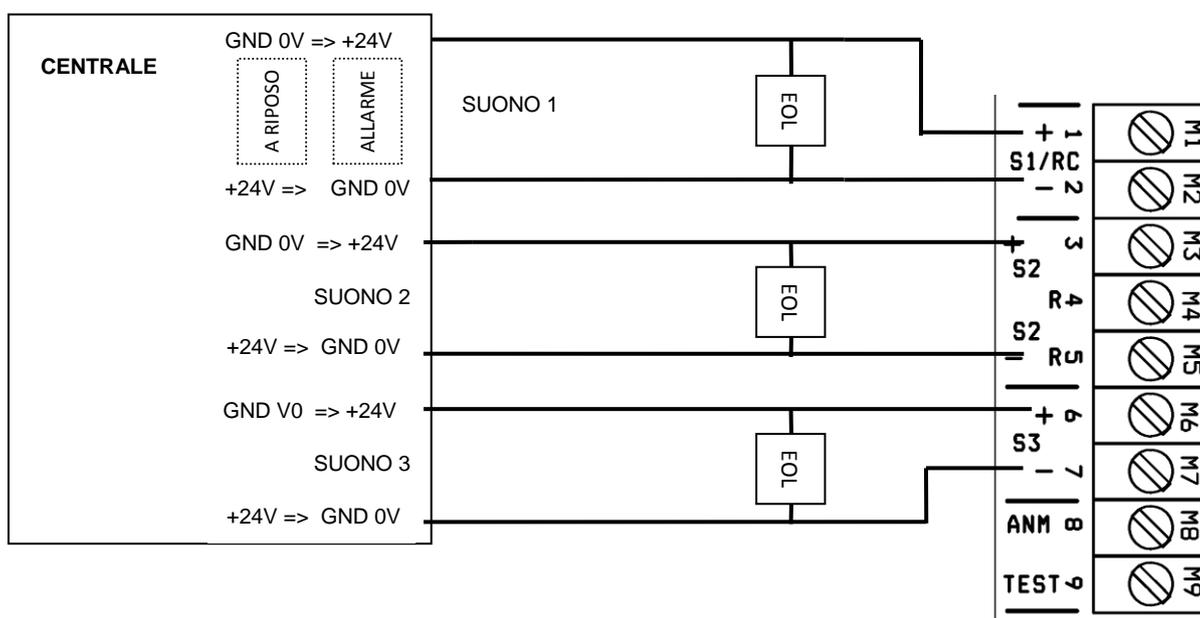
Inserire, la resistenza EOL di fine linea fra i morsetti + e – di ogni suono utilizzato. Il valore della resistenza EOL dipende dal tipo di centrale installata, il suo valore è indicato nel manuale della centrale
