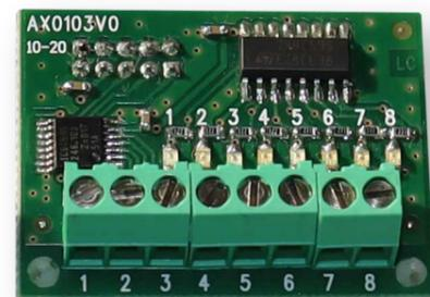
**AX-BSU OUT8** è l'espansione a 8 uscite che consente alla Base Station Universale di raggiungere fino a 24 uscite fisiche (8+8) per una sicurezza ampliata.
