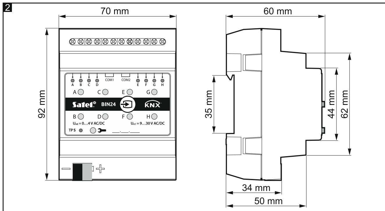
Il modulo occupa 4 unità sulla guida DIN da 35 mm.
