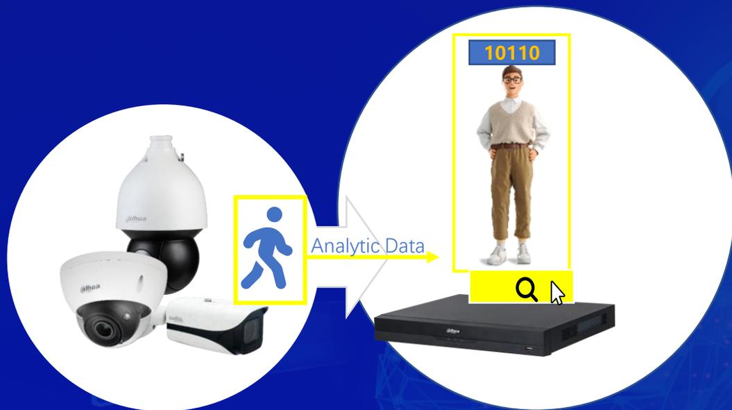
L'IPC e l'NVR possono elaborare efficacemente i dati con una potenza di calcolo intelligente. Sono adatti a scenari di campus di piccole e medie dimensioni con meno di 32 canali, senza la necessità di un server.
