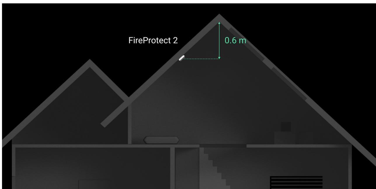
Sconsigliamo di montare il rilevatore su una parete. Una simile installazione è accettabile se travi o altri ostacoli non interferiscono con l'installazione del rilevatore. Un'installazione a parete è possibile solo se il rilevatore è posizionato a una distanza di 15–30 cm dal soffitto ma più in alto delle porte.
