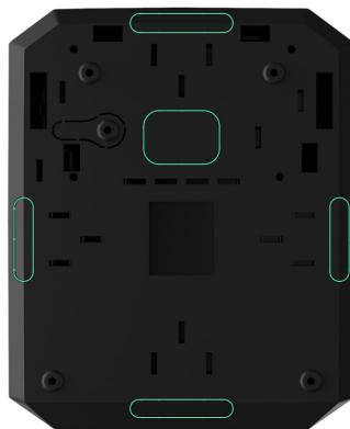
2. Fissare la custodia con le viti in dotazione su una superficie verticale nel luogo di installazione selezionato. Uno di essi si trova nella parte perforata sopra il tamper, serve per attivare il tamper in caso di qualsiasi tentativo di staccare la custodia di MultiTransmitter.
