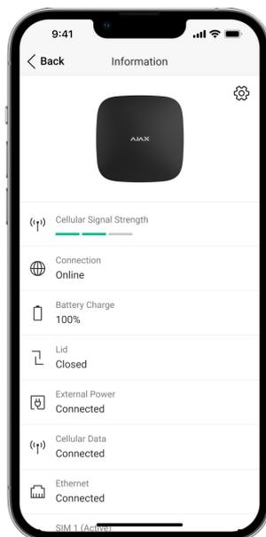
Gli stati includono informazioni sul dispositivo e i suoi parametri di funzionamento. Gli stati di Hub 2 possono essere visualizzati nell'[app Ajax](#):
