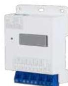
Modulo relè aggiuntivo su RS485 indirizzabile, 2 porte RS485 per collegamento in cascata, 8 ingressi allarme per collegamento pulsanti, opzione di installazione su barra DIN, alimentazione 12 Vdc <1 W fornita dal VTO
