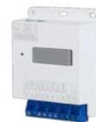
Modulo relè aggiuntivo su RS485 indirizzabile, 2 porte RS485 per collegamento in cascata + 1 porta RS485/Wiegand per collegamento lettore, 1 relè per controllo carico fino a 230V, opzione di installazione su barra DIN, alimentazione 12 Vdc <1 W fornita dal VTO
