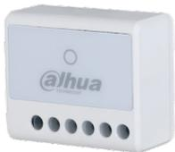
Relè wireless da interno con 1 input allarme per antimanomissione (NO/NC), 1 output relè (NO/NC 0~36 Vdc, max. 5A), 1 indicatore luminoso, 1 tasto, update remoto tramite cloud, modalità test, frequenza portante 868~868.6 MHz, comunicazione bidirezionale, salto di frequenza, crittografia AES128, alimentazione 7~24 Vdc
