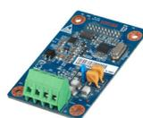
Comunicatore telefonico PSTN per ARC3008C, protocollo CID per invio segnalazione allarmi a stazione di monitoraggio tramite linea fissa
