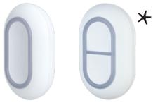
Pulsante antipanico wireless IP54, indicatore di stato luminoso, 1 o 2 tasti, update remoto tramite cloud, potenza segnale, segnalazione batteria scarica (verificabile anche su app), frequenza portante 868~868.6 / 433.1~434.6 MHz, comunicazione bidirezionale, crittografia AES128, salto di frequenza, molteplici allarmi supportati (intrusione, incendio, fughe di gas...), batteria CR2032 (durata 5 anni)
