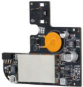
Modulo PSU 12 Vdc per HUB 2 AirShield (ARC3800H-FW2-868), tensione di esercizio 6-24 Vdc
