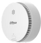
Rilevatore di fumo wireless da interno, sensore fotoelettrico, indicatore LED luminoso, allarme fumo, guasto, segnalazione batteria scarica (volume 85~90 dB(A) a 3 m), area copertura 20~40 m<sup>2</sup>, tasto test/silenzioso, comunicazione bidirezionale, frequenza portante 868~868.3 MHz, crittografia AES128, salto di frequenza, 3 batterie CR123A (durata 3 anni), certificazione EN 14604:2005, AC:2008
