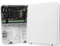
Modulo trasmettitore a 16 ingressi filari e 4 uscite relè a scambio libero, tipo ingressi NC-NO, bilanciamento singolo, doppio e triplo con valori resistivi programmabili liberamente, porta LAN, trasmissione 868 MHz bidirezionale, alimentazione 230 Vac/PoE, batteria tampone 7Ah, tensione di uscita 14 Vcc @ 2 Amps con alimentatore, tensione di uscita 14Vcc @ 0,75 Amps alimentata PoE, box plastico 304x235x90.8 mm
