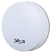
Rilevatore di liquidi wireless IPX5, indicatore di stato luminoso, 1 tasto, update remoto tramite cloud, potenza segnale, segnalazione batteria scarica (verificabile anche su app), frequenza portante 868~868.6 MHz, comunicazione bidirezionale, crittografia AES128, salto di frequenza, batteria CR123A (durata 3 anni)
