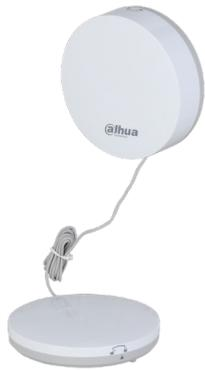
Rilevatore di liquidi (sensore separato) wireless IPX5, indicatore di stato luminoso, 1 tasto, update remoto tramite cloud, potenza segnale, segnalazione batteria scarica (verificabile anche su app), frequenza portante 868~868.6 MHz, comunicazione bidirezionale, crittografia AES128, salto di frequenza, batteria CR123A (durata 3 anni)
