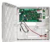
Centrale completa di contenitore con 6 moduli integrati : **moduli LTE doppia SIM / ETHERNET / PSTN / scheda vocale con ascolto ambientale.**
