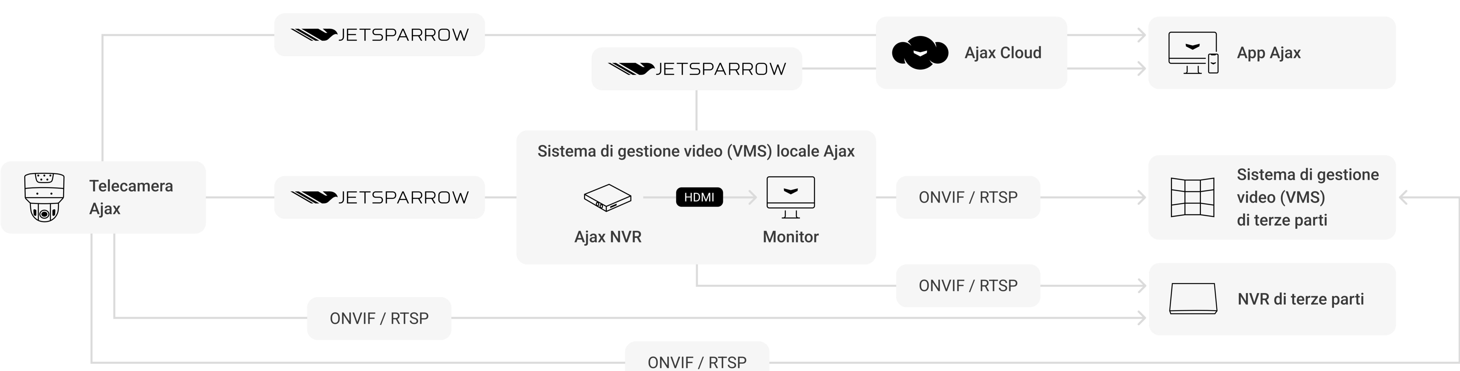
☞ Le telecamere Ajax Superior DomeCam HLVF possono funzionare senza Ajax NVR: l'archivio video viene memorizzato localmente su una scheda microSD, se installata.
