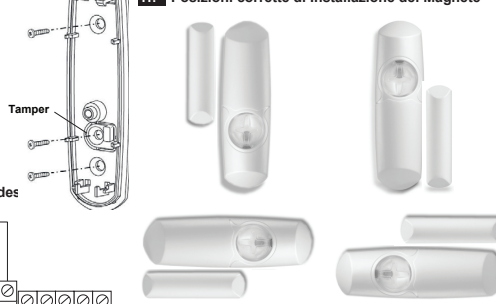
Figure 3 EN: Magnet Mounting Positions FR: Montage du Contact Magnétique ES: Posiciones de montaje del Imán IT: Posizioni corrette di installazione del Magnete
